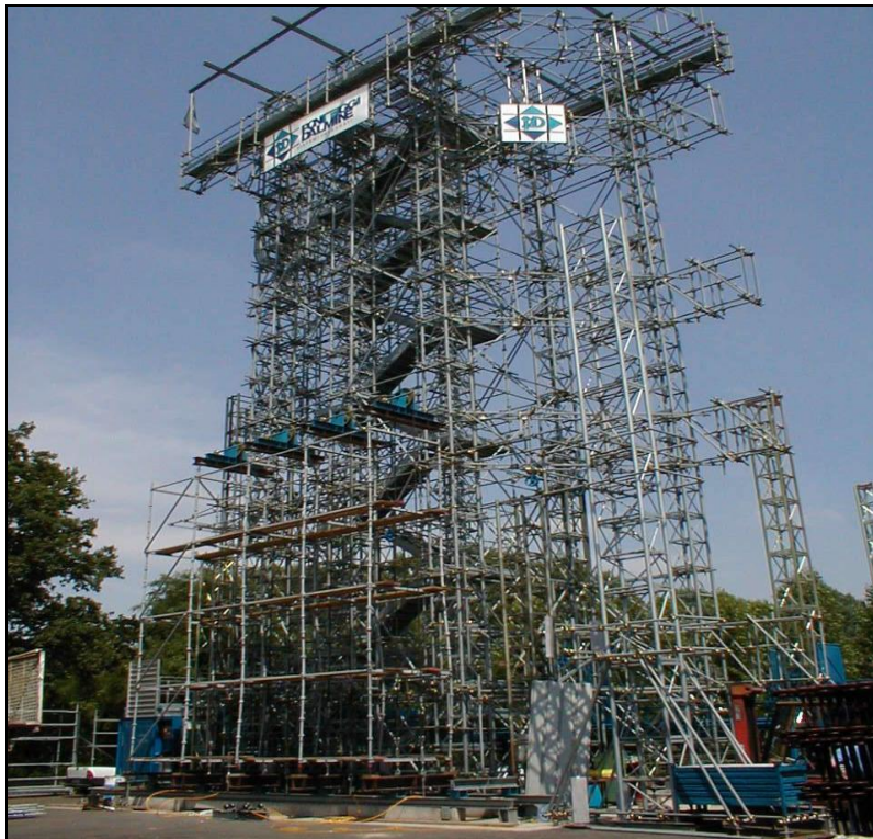
Fig. 7: test su prototipo in scala a vero, campo prove PoliMI.
