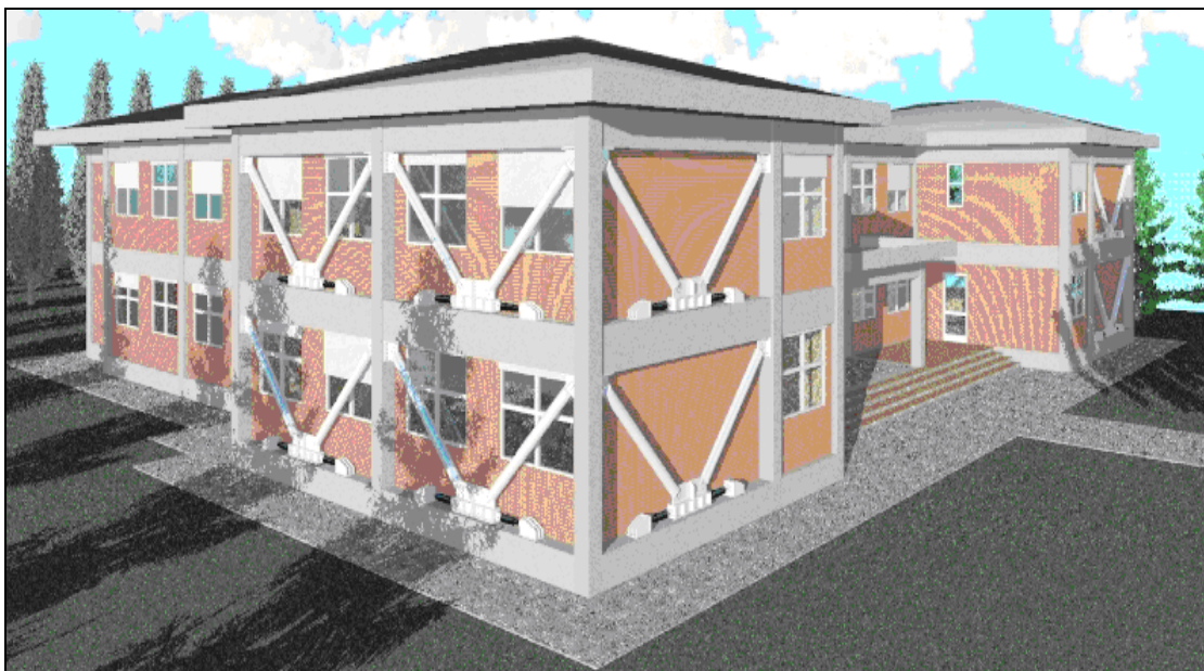
Fig. 9: ipotesi di adeguamento sismico con controventi fluido-viscosi
